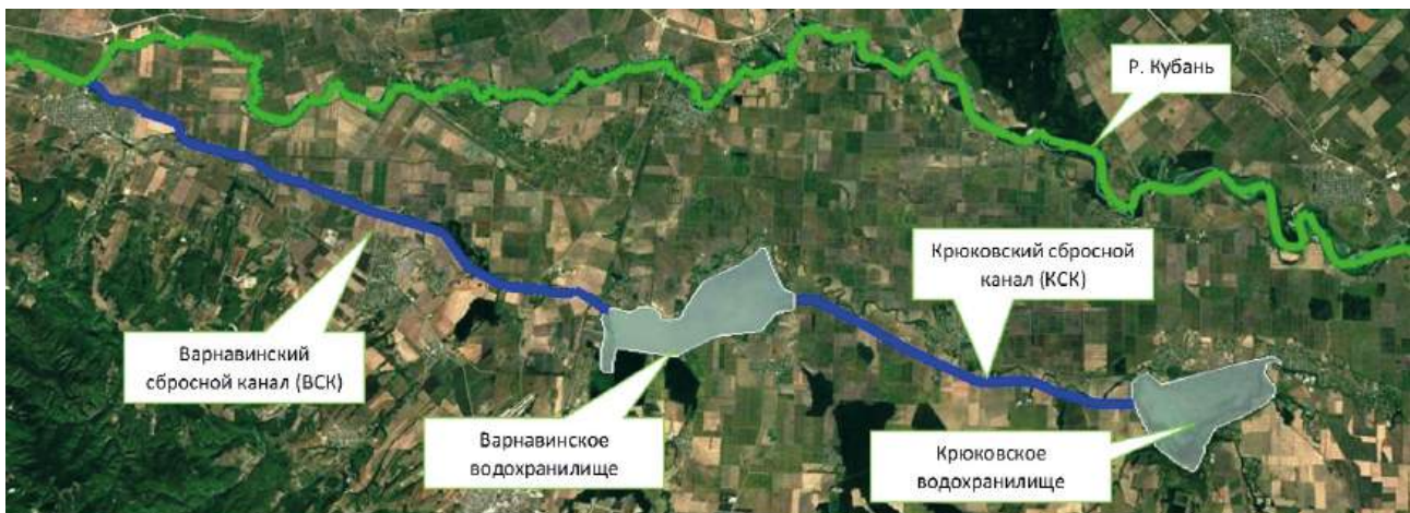
Рисунок 1. Схема каскадного распределения водных ресурсов из Крюковского водохранилища в р. Кубань
