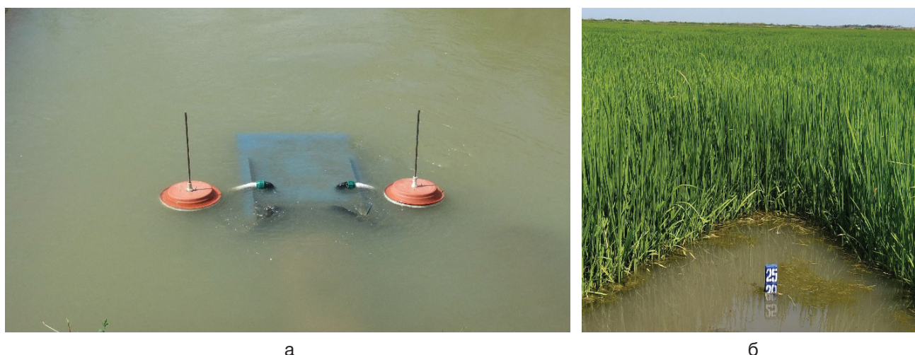
Рисунок 1. Гидроавтомат, поддерживающий слой воды на чеке (а); водомерная рейка (б); (КФХ «Вороня О.А.», 2024 г.)
